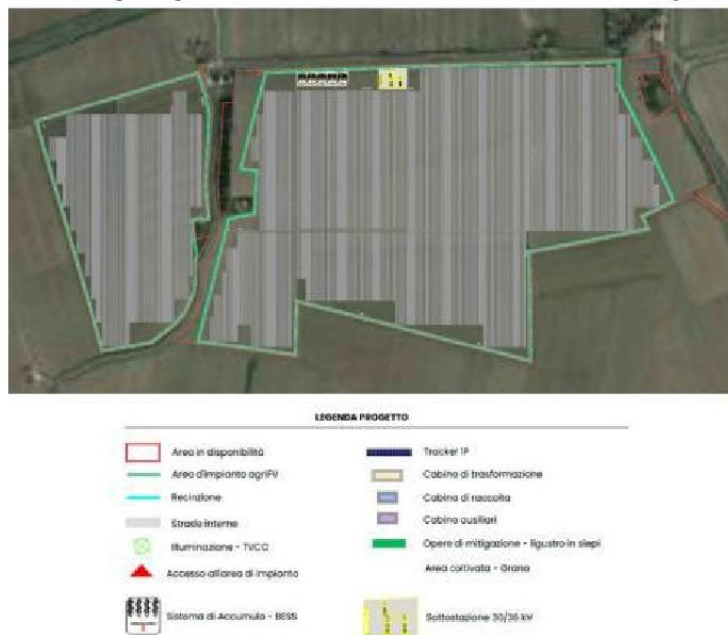
Figura 2- Layout di impianto su base ortofoto
